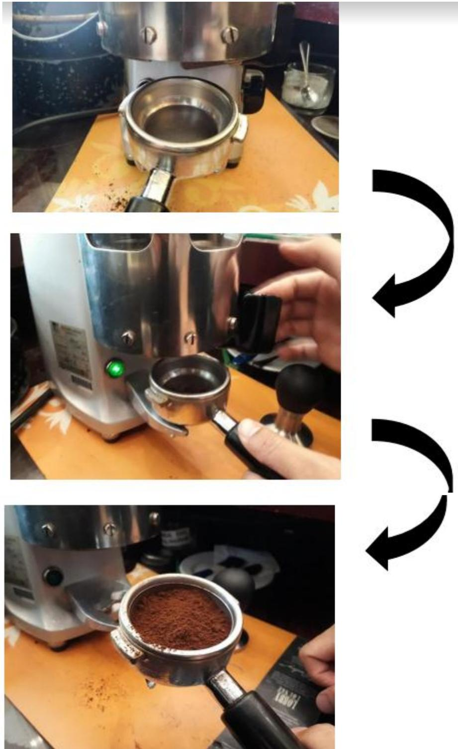
Gambar 8. Proses Inject bubuk kopi, hasil proses Grinding kedalam portafilter dengan total Gramasi untuk Single Shoot Perfect Espresso (9 gr)
